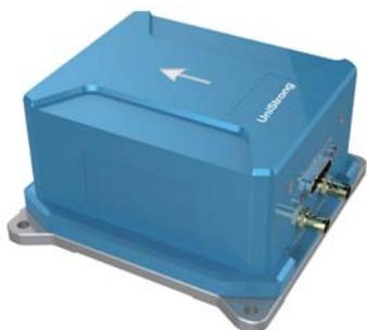
UGM532是一款小型化高精度GNSS惯性组合导航系统，产品内置高精度GNSS接收机与高精度MEMS陀螺，加速度计。UGM532搭载全新设计的组合导航算法引擎，在多路径干扰、卫星遮挡严重以及卫星失锁环境下，持续输出高精度、稳定的位置姿态信息。为满足测量测绘领域的高精度要求，UGM532具备原始数据存储功能，配套导航后处理软件，为用户提供更高精度的定位姿态数据。产品支持外接多种传感器，如里程计、气压计和地速雷达等，提升系统的实时性能和稳定性。
